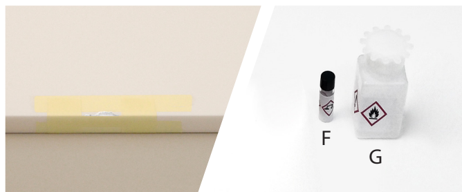
4. Perimetrare l'area da riparare con nastro adesivo crespato e versare tutto il catalizzatore (F) dentro la boccetta del Gelcoat (G) e mescolare fino ad ottenere una miscela omogenea.
